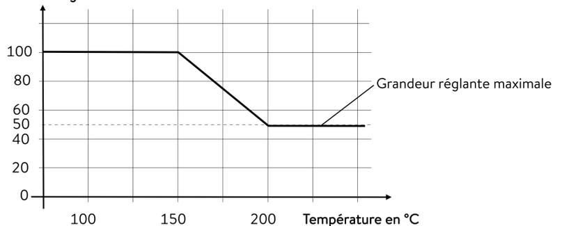
Fig. 38: Limitation dynamique de la puissance de chauffe
