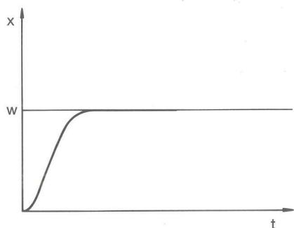
Fig. 65: Réglage optimal
