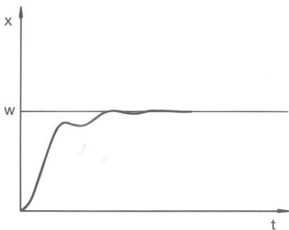
Fig. 67: Paramètre de contrôle  $X_p$  trop petit
