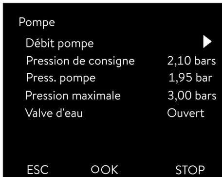
Fig. 29: Menu Pompe sur les appareils Integral IN XT
